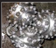
Долото отработало с ЭЖГ 85 ч для бурения интервала 2278-2766 м (488 м) на скважине № L 8165 в Ливии, увеличение скорости бурения составило 71,5 %
