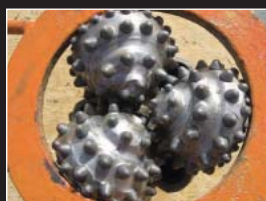
Долото отработало с ЭЖГ 85 ч для бурения интервала 2278-2766 м (488 м) на скважине № L 8165 в Ливии, увеличение скорости бурения составило 71,5 %
